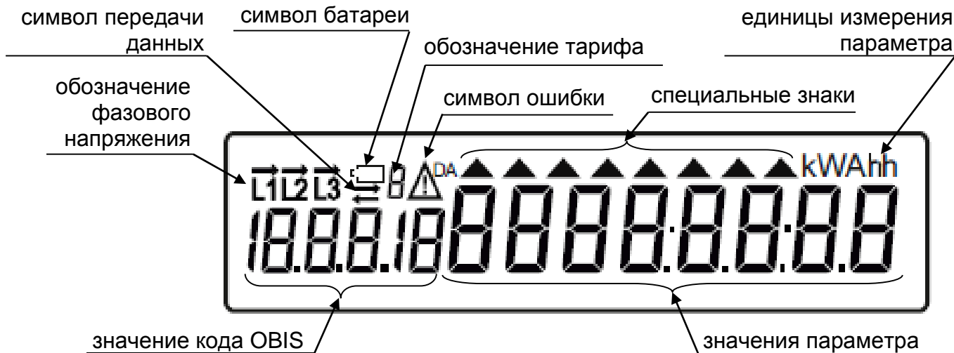
Рисунок 3.1 – Внешний вид дисплея счетчика со всеми включенными сегментами
